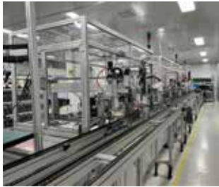
汽车整车控制器自动化生产线
